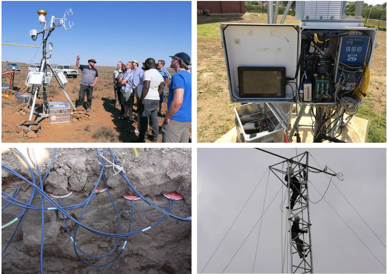
Abbildung 1.2: Einführung der Karoo-Tower-Infrastruktur in das ARS AfricaE-Konsortium durch den TI-AK-Ingenieur J.-P. Delorme (oben links); Einbau von Erdwärmesonden (unten links); Nahaufnahme des Vuwani Biomet-Systems (oben rechts); Aufarbeitung im Vuwani-Turm (unten rechts).
