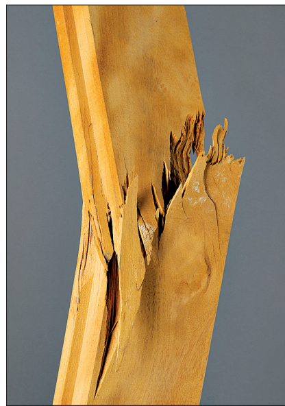
Gebrochene Ausfachungsbohle aus Bilinga Foto: Thünen-Institut
