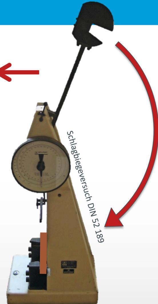
Bruchschlagarbeit: Energie in  $\text{kJ/m}^2$ , die bis zum Bruch aufgenommen wird
