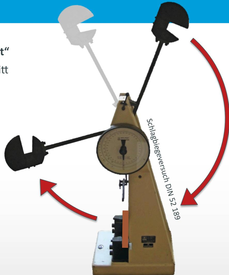
Bruchschlagarbeit: Energie in kJ/m<sup>2</sup>, die bis zum Bruch aufgenommen wird
