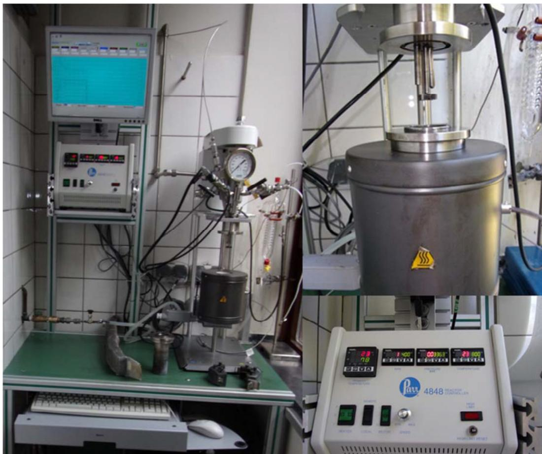
**Abbildung 4:** Laboraufbau mit Hochdruckrührautoklav (Fa. Parr, 50 ml, 450°C, 350 bar)
