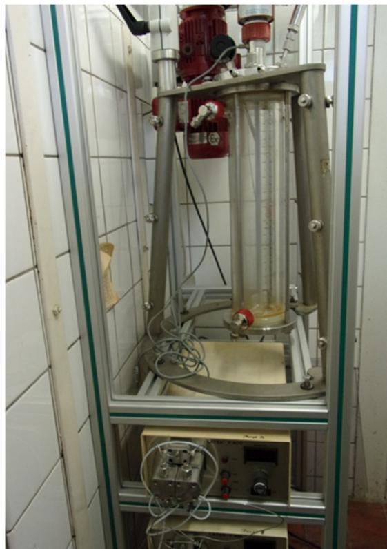
**Abbildung 22:** Montage eines Glasreaktors (Fa. Büchi) zur Bereitstellung des Eduktes
