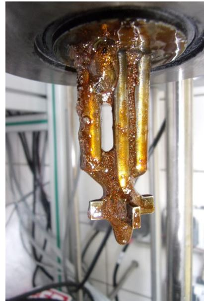
**Abbildung 14:** Ölprodukt nach Konversion von proFagus-Öl bei 120°C, 200 bar H<sub>2</sub>, 60 min Reaktionszeit, 10 Ma.-% Raney-Nickel 4200 (Edukt<sub>wf</sub>)
