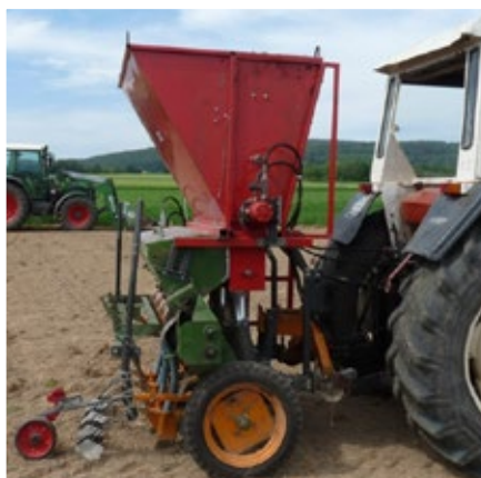
Prototyp einer Maschinenkombination aus Kompostbunker und Drillmaschine zur Kompostausbringung der Saatreihe und eine Detailabbildung der Saatschare des Prototyps (Bild: D. Werren, Universität Kassel)
