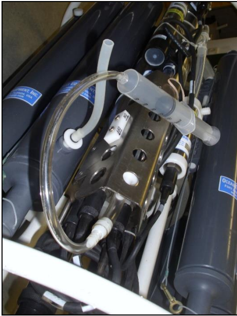
Abb. 12. Sensorzellenreinigung (mit Tritonlösung, Süßwasser oder De-Ionized Wasser)
