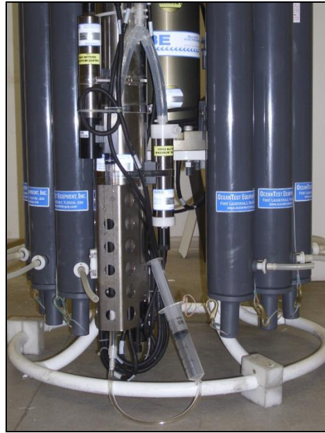
Abb. 12. Sensorzellenreinigung (mit Tritonlösung, Süßwasser oder De-Ionized Wasser)
