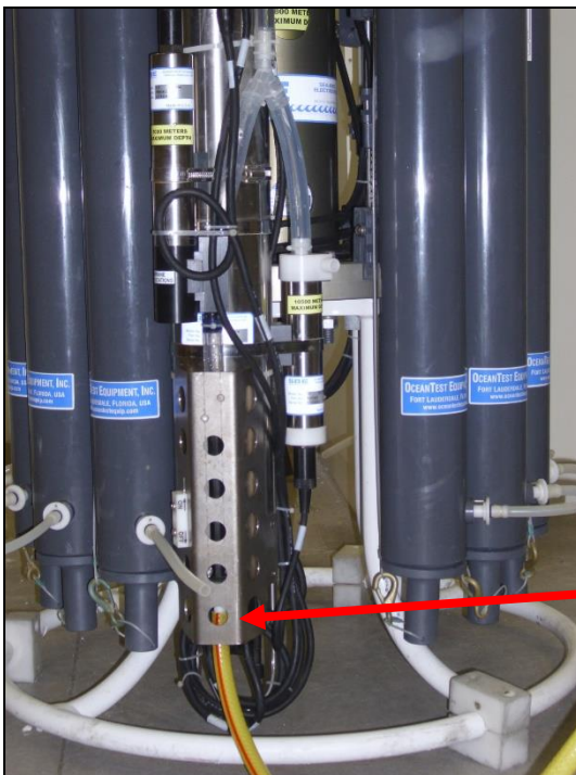
Abb. 13. Sensorzellenreinigung mit Süßwasser
