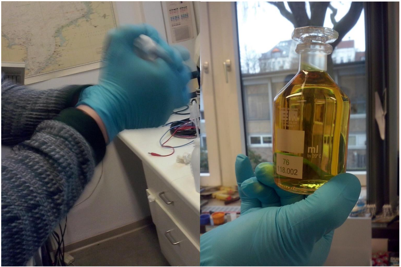
Abbildung 12: Links: Schütteln der Sauerstoffflasche, um flockigen Niederschlag vollkommen zu lösen. Rechts: Korrekte Trübe der Messlösung.
