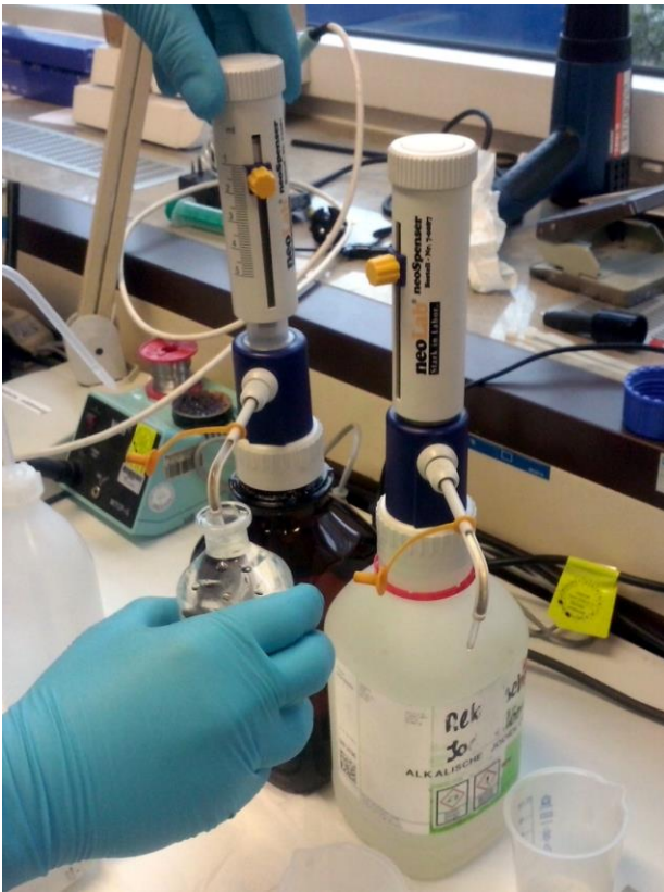
Abbildung 9: Versetzung von Mangan-Reagenz und alkalischer Jodidlösung
