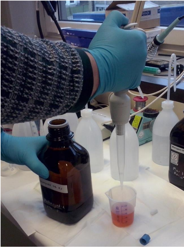
Abbildung 7: Pipettierung von Chemikalien (im Bild: Kaliumjodid) für die Bestimmung des Titers.
