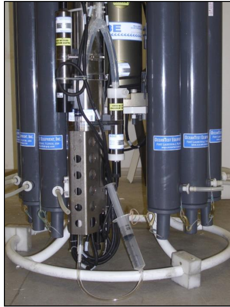
Abb. 12. Sensorzellenreinigung (mit Tritonlösung, Süßwasser oder De-Ionized Wasser)
