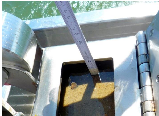
Abbildung 3: Messung des Füllstands eines van Veen-Greifers. Foto : Matthias Pauli (Thünen)
