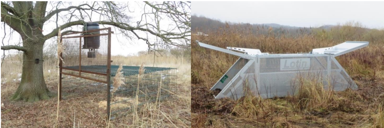
Abbildung 2: Mobile Drahtgitterfalle mit Futterautomat (links) und Mobile Metallkastenfalle, Fa. Lotin/ Schweden (rechts)
