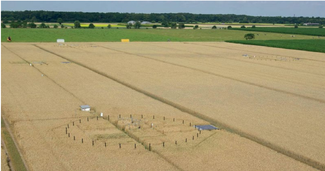
FACE-Versuchsfeld mit CO 2 -Begasungsringen (Ø 20 m). Durch Düsen an den senkrechten Stangen wird während der Vegetationsperiode computergesteuert CO 2 ins Ringinnere geblasen, sodass dort die mittlere CO 2 -Konzentration etwa 550 ppm beträgt (normale Umgebungsluft kurzzeit 390 ppm).
