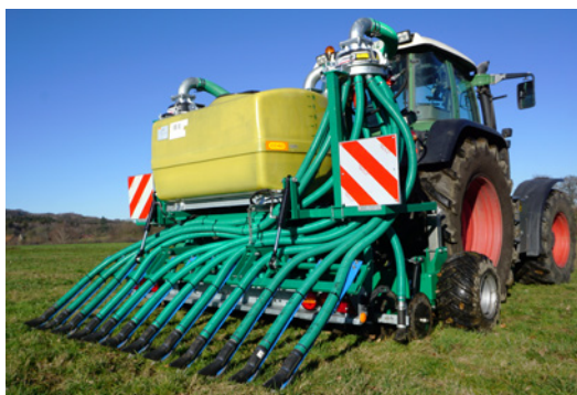
Eingesetzte Versuchstechnik zur Gülleausbringung mit Schleppschlauch/-schuh oder Schlitztechnik.
