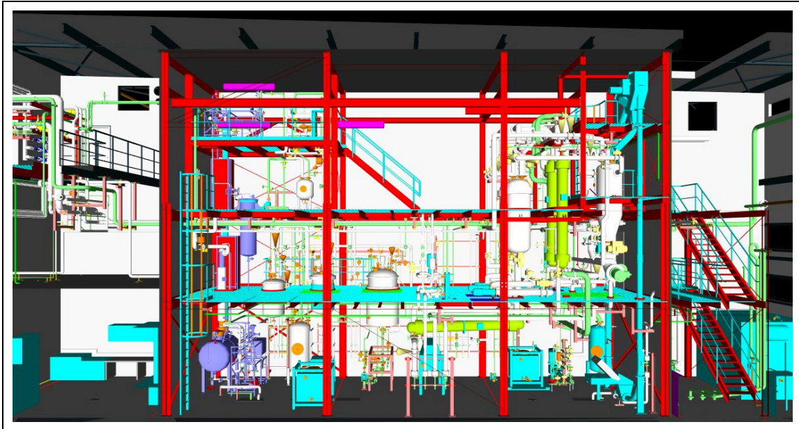
Abb. 70: Layout der Pilotanlage (Aufschluss und Ligninfällung) (Quelle: CBP)
