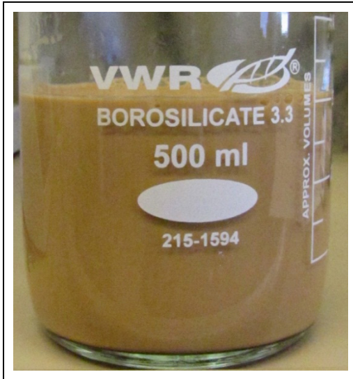
Abb. 64: Sumpffraktion aus thermischer Ligninfällung nach 2 h Standzeit (Quelle: BTS).
