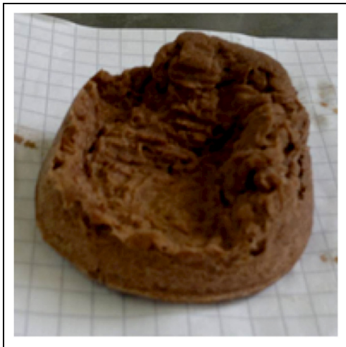
Abb. 52: Cellulose-Faserkuchen nach Filtration (Quelle: BTS)
