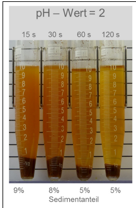
Abb. 68: Sumpffraktion @ pH 2 bei unterschiedlichen Zentrifugationszeiten (3.000 × g) (Quelle: BTS)
