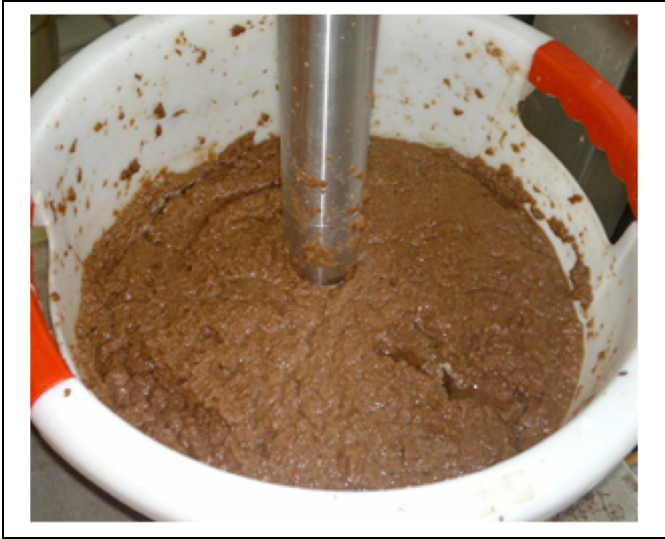
Abb. 47: Organosolv-Fasern nach der Zerkleinerung (Quelle: BTS)
