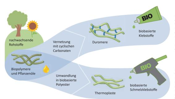
Bei der Vernetzung werden einzelne Moleküle zu einem festen, unlöslichen Polymer-Netzwerk verbunden. Die so erhaltenen Duromere sind stabile, nach dem Aushärten nicht mehr verformbare Kunststoffe, die als Klebstoffe dienen können.
