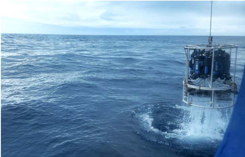
Eine hydrografische Sonde mit Kranzwasserschöpfer zur Bestimmung von Salzgehalt und Temperatur mit der Wassertiefe.
