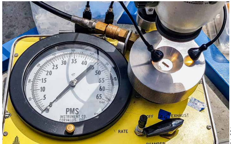
Abb. 3: Mit der als Scholanderbombe bezeichneten Druckkammer wird das Wasserpotenzial bestimmt. Indem der Druck in der Kammer erhöht wird, wird Wasser aus einem eingespannten Blattstiel herausgepresst.
