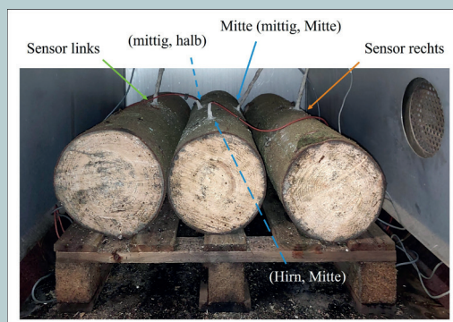
Abbildung 3: Positionen der Temperatursensoren in den Stammabschnitten
