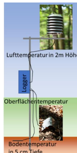
Abbildung 2: Schematische Darstellung der vor direkter Sonnenstrahlung geschützten Temperatursensoren und ihrer Messhöhe.
