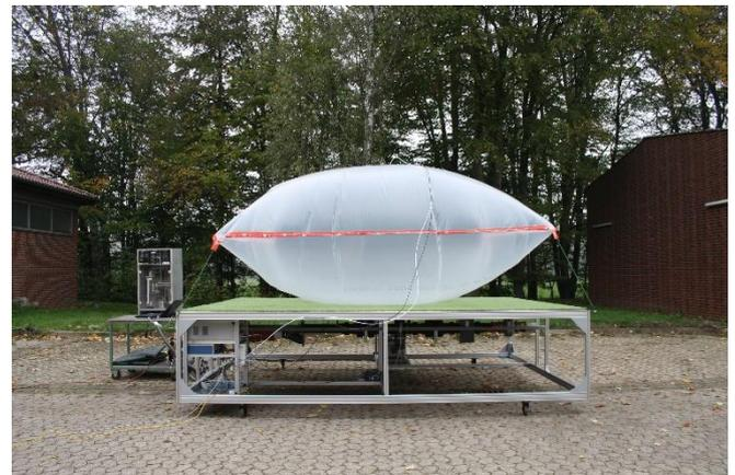
Abbildung 1: Neuartige Prüfkammer, voll aufgeblasen
