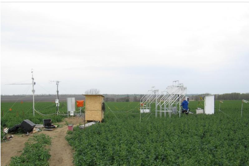
Ökosystem-Messstation des Thünen-Instituts zur Erfassung der Treibhausgasflüsse zwischen Boden, Vegetation und Atmosphäre.
