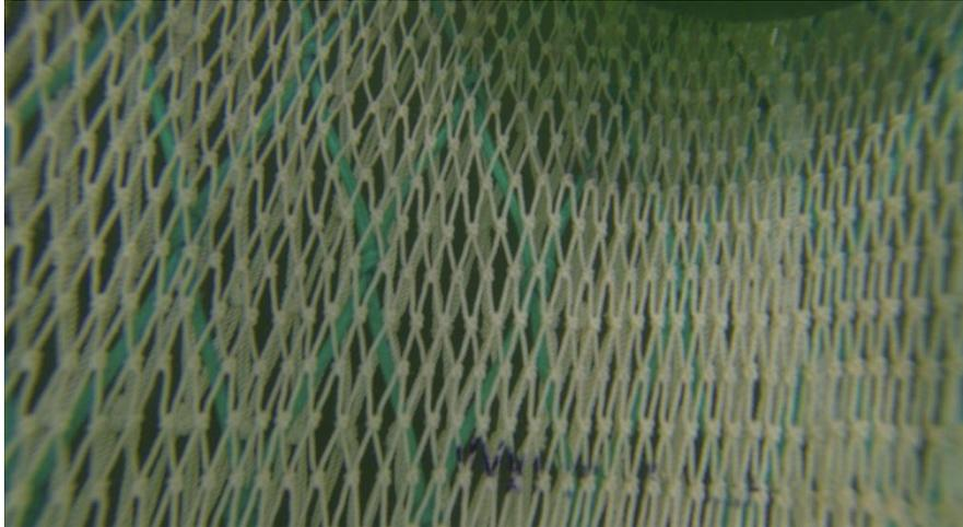
**Abbildung 12: GoPro-Kamera fotografierte das Unterblatt des T0 – 20 Steertes des DYFS-Netzes im mittleren Bereich von innen mit darunter liegenden Hievsteertmaschen (grün) sowie weiter darunter liegenden, weißen, größeren Maschen des Scheuerschutzes**
