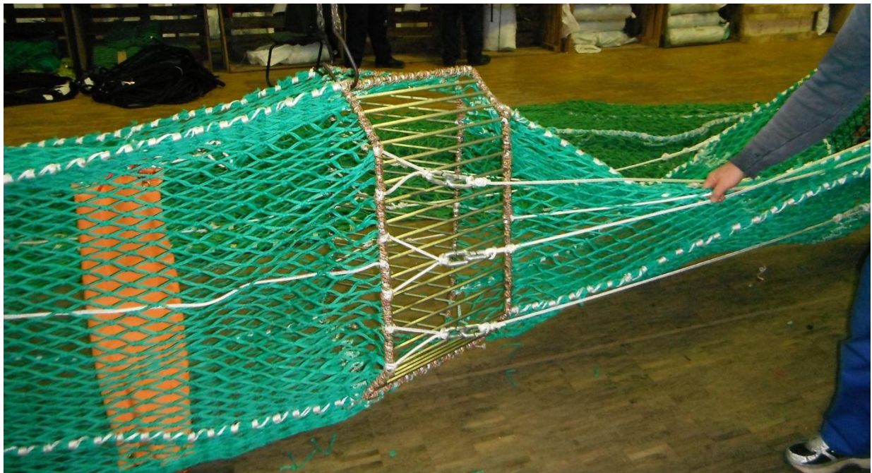
Abbildung 34: Die Stahlgitter im Schleppnetzunnel Figure 34: The steel grids in the trawl extension
