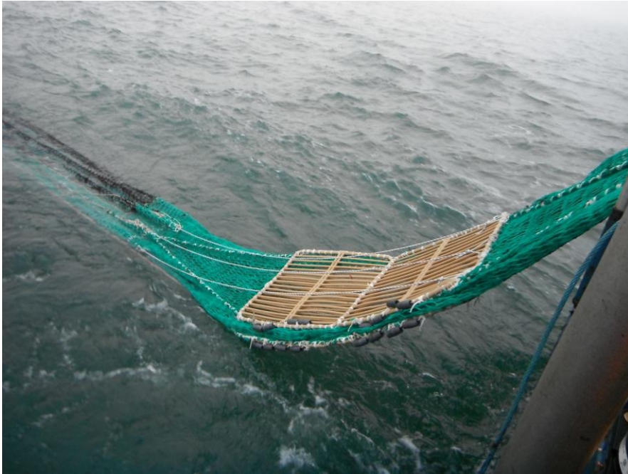
Abbildung 9: Die flexiblen Gitter der Firma OCTech beim Aussetzen des Schleppnetzes Figure 9: The flexible grids of the French company OCTech when shooting the trawl
