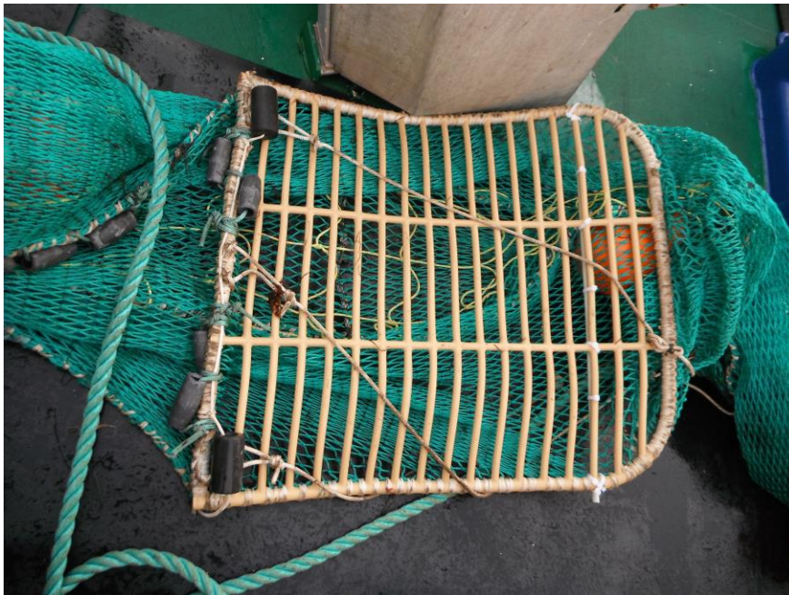
Abbildung 7: Flexibles horizontal um 30° geneigtes Gitter mit Bleigewichten Figure 7: horizontally 30° inclined flexible grid with lead weights
