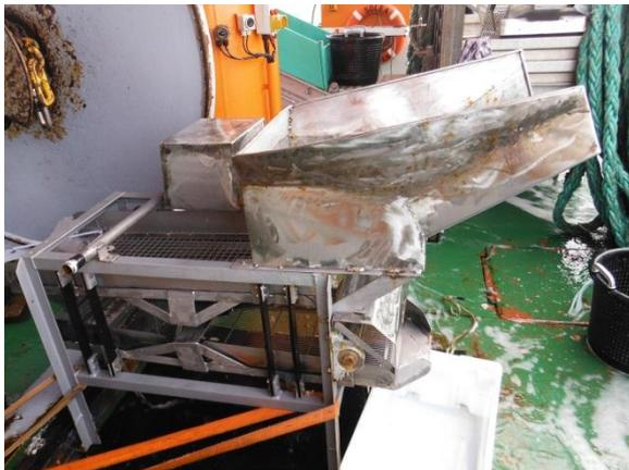
**Abbildung 4:** Siebmaschine an Bord der Solea.
